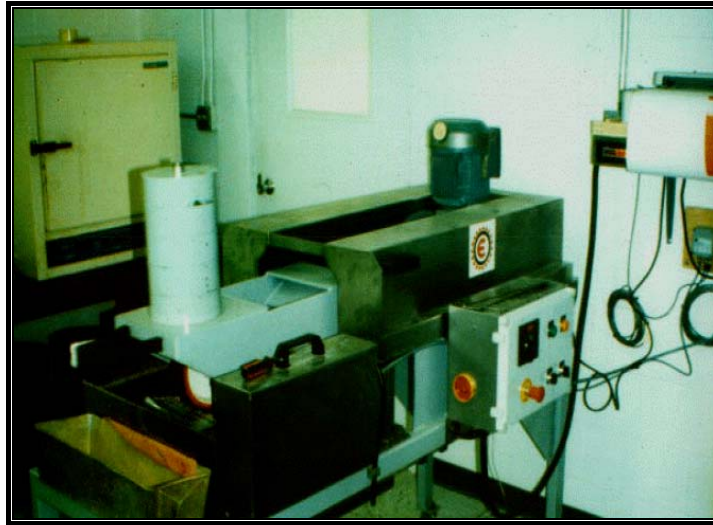
Fotografía 4.7 Superfos Construction Rut Testers. Referencia, (19).
