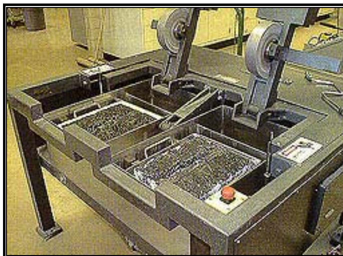
Fotografía 4.1 Máquina de Ensayo de Hamburgo. Hamburg Wheel Tracking Device. Referencia, página web (11).
