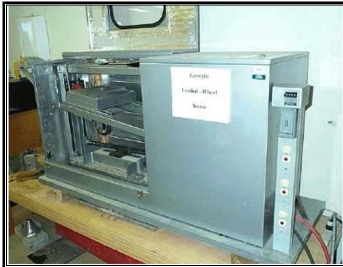
Fotografía 4.5 Máquina para realizar ensayos de deformaciones plásticas de la Universidad de Wyoming U.S.A. tipo GLWT. Referencia, página web (11).
