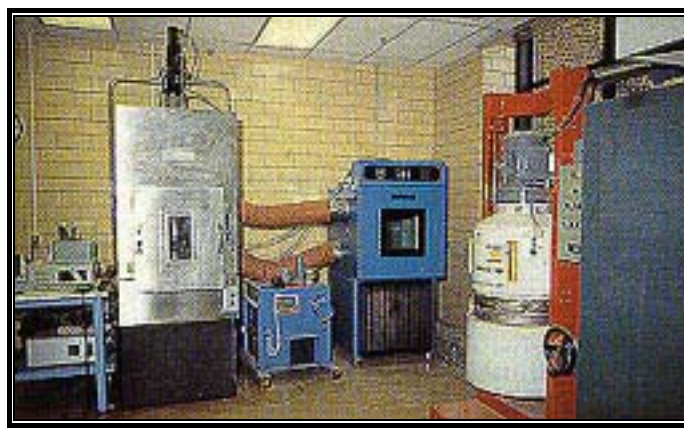
Fotografía 4.4 Máquina de SST. Superpave. The Superpave Shear Tester (SST). Referencia, página web (11).
