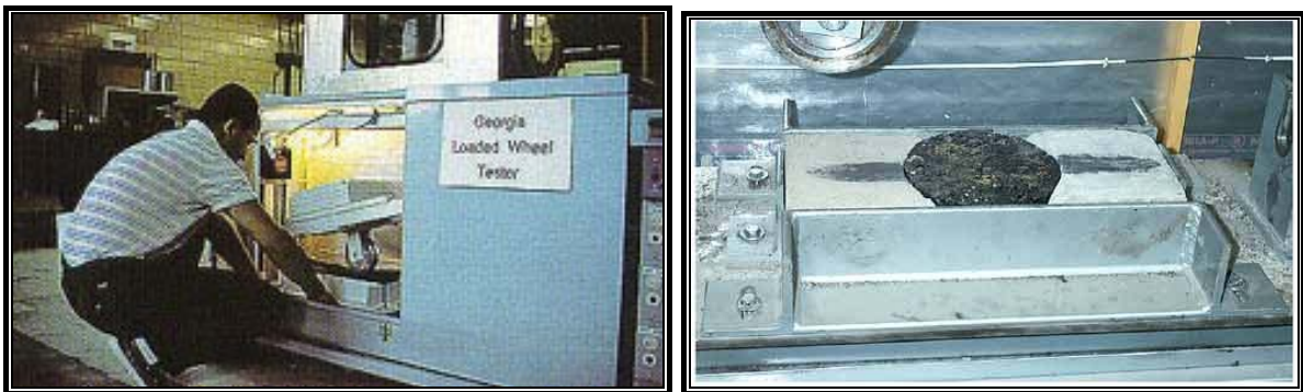
Fotografía 4.3 Máquina de Ensayo de Georgia. The Georgia Loaded – Wheel Tester. Referencia, página web (11).
