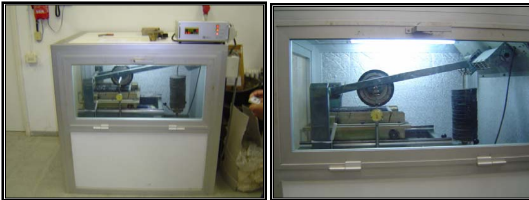
Fotografía 4.10 Máquina de Pista NLT. Laboratorio de Caminos de la Universidad Politécnica de Catalunya. Barcelona.
